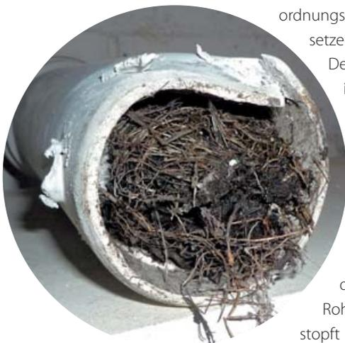
Der Bauverein hat schon in mehreren Objekten die Prüfung der Rohre und auch ihre Sanierung vorgenommen, wo das erforderlich war. Wurzeln beispielsweise sind häufig die „Übeltäter“, wenn Rohre undicht oder verstopft sind (Bild).
